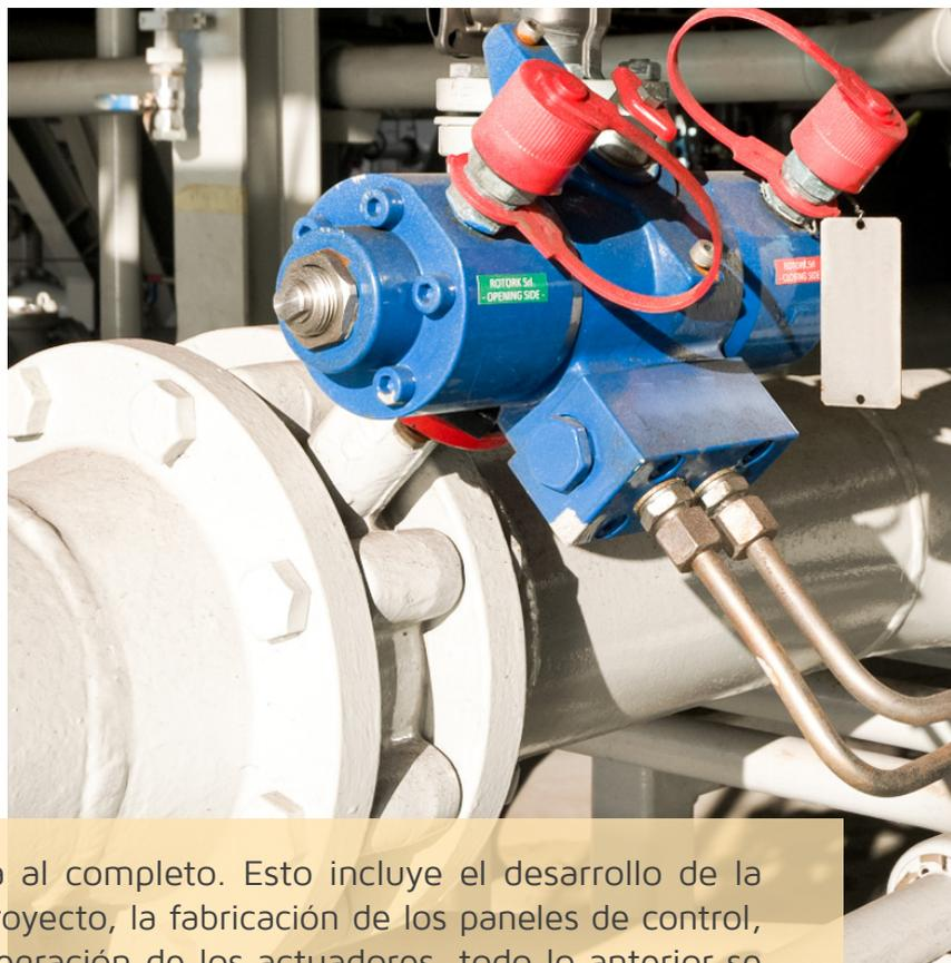
FJ ofrece el alcance de trabajo del sistema al completo. Esto incluye el desarrollo de la ingeniería, partiendo de la información del proyecto, la fabricación de los paneles de control, la fabricación de las válvulas SAVAL y la integración de los actuadores, todo lo anterior se complementa con paquetes de documentación logística y técnica, así como el soporte técnico durante la instalación, la puesta en marcha y el ciclo de vida.
